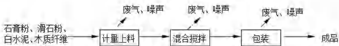
图 2-2 轻质建筑材料生产工艺流程及产污节点图
